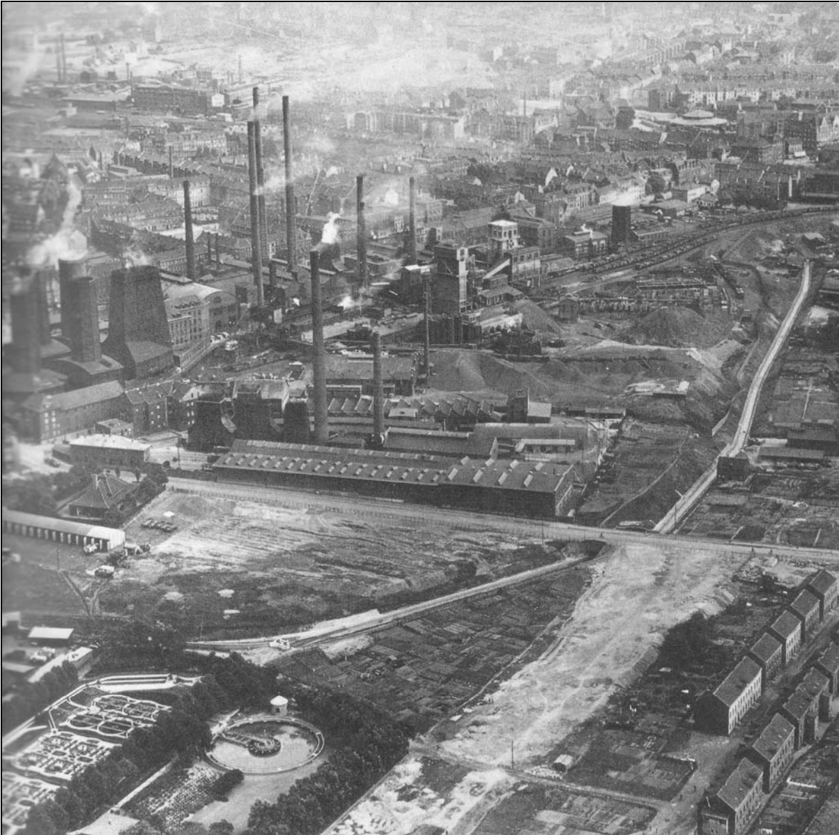
Vista aérea de parte da região do Ruhr. Como elemento central, um córrego canalizado nas formas tradicionais para o carreamento dos esgotos. Fonte: IBA-Internationale Bauausstellung Emscher-Park
