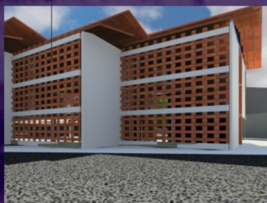
Cobogó de 45°. No pôr do sol do solstício (a pior hora do pior dia em termos de angulação do sol), o cobogó filtra 73% da radiação solar direta.
