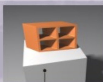
Cobogó de 45°. No pôr do sol do solstício (a pior hora do pior dia em termos de angulação do sol), o cobogó filtra 73% da radiação solar direta.
