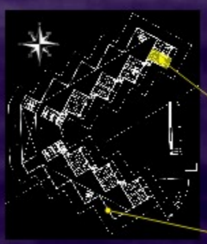
Cobogó de 45°. No pôr do sol do solstício (a pior hora do pior dia em termos de angulação do sol), o cobogó filtra 73% da radiação solar direta.
