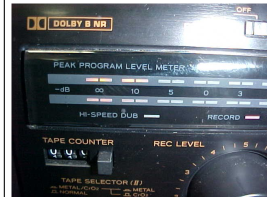
V.U. DE GRAVAÇÃO 4º passo (O bom nível de gravação é 0 decibéis)
