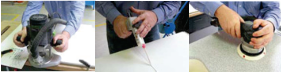
Corte, colagem e polimento
