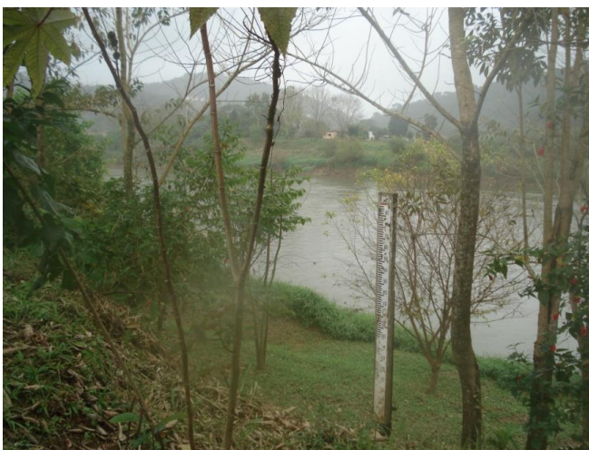
Figura 5: Régua para marcação da altura em que o rio sobe. Foto: Lara Leite Barbosa.
