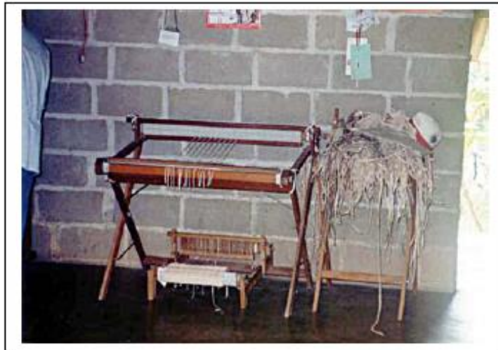
Figura 9 - Tear de pente liço de cavalete e tear de mesa (no chão). Ao lado direito da foto fibras de bananeiras prontas para serem tecidas
