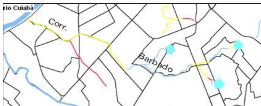
Figura 1: Mapa hidrográfico do córrego do Barbado (azul: leito natural; amarelo: canalização aberta; vermelho: canalização fechada, círculo azul claro: nascentes). Fonte: adaptado de Instituto de Planejamento e Desenvolvimento Urbano de Cuiabá.
