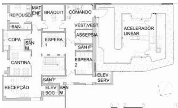
Figura 3- Planta pavimento térreo.
