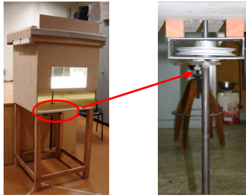
Figura 8 – Mecanismo para Suspensão da Base do Céu Artificial.
