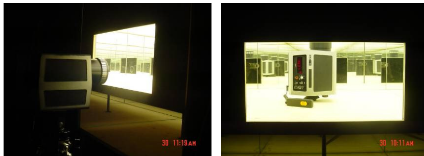
Figura 9 – Foto do Luminômetro posicionado para calibragem do céu artificial.
