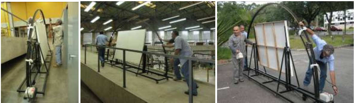
Figura 10 – Fechamento e transporte do heliodon da oficina do LAME para o edifício Vilanova Artigas, da FAUUSP (fotos: D. Duarte)
