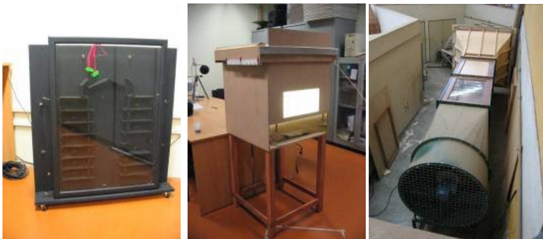
Figura 15 – Da esquerda para a direita, simulador de efeito chaminé (ME Eduardo O. Vianna), céu artificial (IC Bruna Luz e Luciana Ferreira, DO Norberto Moura) e túnel de vento de camada limite atmosférica (IC Alex Uzueli, ME Daniel Cóstola, DO Alessandra Prata), outros projetos desenvolvidos na parceria LABAUT/LAME.
