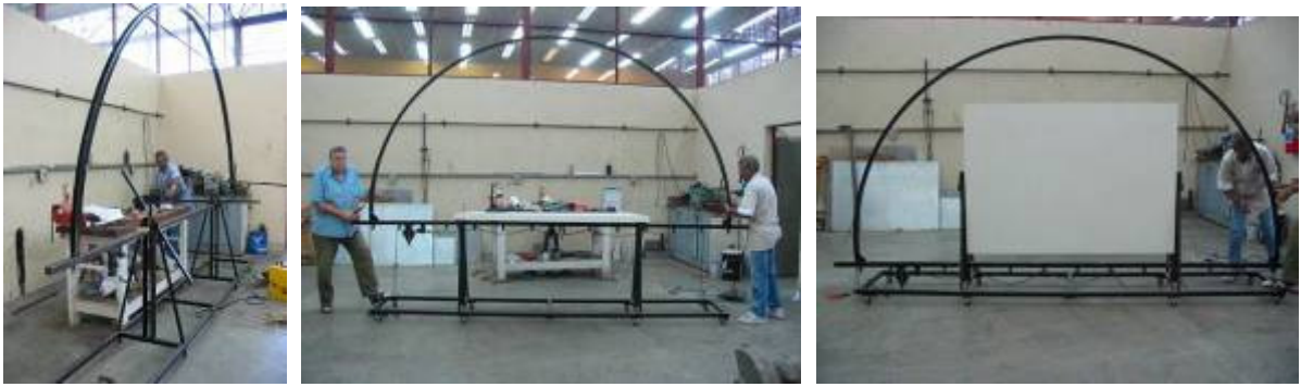
Figura 9 - Da esquerda para a direita: construção do heliodon, equipamento em posição de uso para os ensaios e posicionado para transporte.(fotos: M. Bueno Souza)
