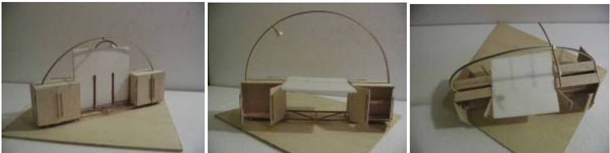
Figura 3 - Modelo em escala 1:10 de uma das versões, em posição de armazenamento e transporte, à esquerda, e em posição de uso, no centro e à direita (fotos: M. Bueno Souza).
