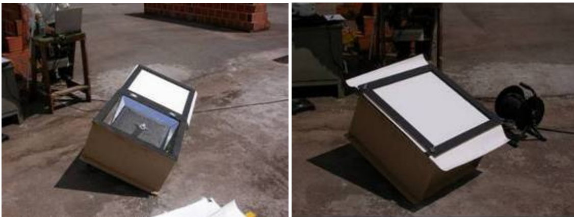
Figura 14 – Caixa de ensaio de transmissão térmica e luminosa em membranas conforme norma ASTM 1084-86 (1996), Auxílio à pesquisa CNPq M.Alucci.
