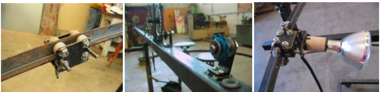
Figura 8 - Da esquerda para a direita: carrinho da lâmpada, barra deslizante de sustentação do arco e lâmpada. (fotos: M. Bueno Souza)
