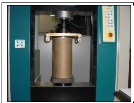
Figura 11 – Corpo-de-prova durante o ensaio de resistência à compressão. Fonte: SALADO, 2006, p. 128.
