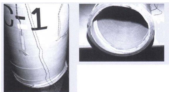
Figuras 05 e 06 – Aspecto dos tubos após o teste de resistência à compressão, para a Casa de Papelão. Fonte: McQuaid, 2003, p.75.
