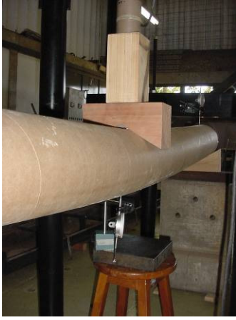
Figuras 16 e 17 – Corpo-de-prova durante o ensaio de resistência à flexão. Fonte: SALADO, 2006, p. 141.
