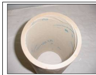
Figura 14 – Ondulações formadas no corpo-de-prova. Fonte: SALADO, 2006, p.131.
