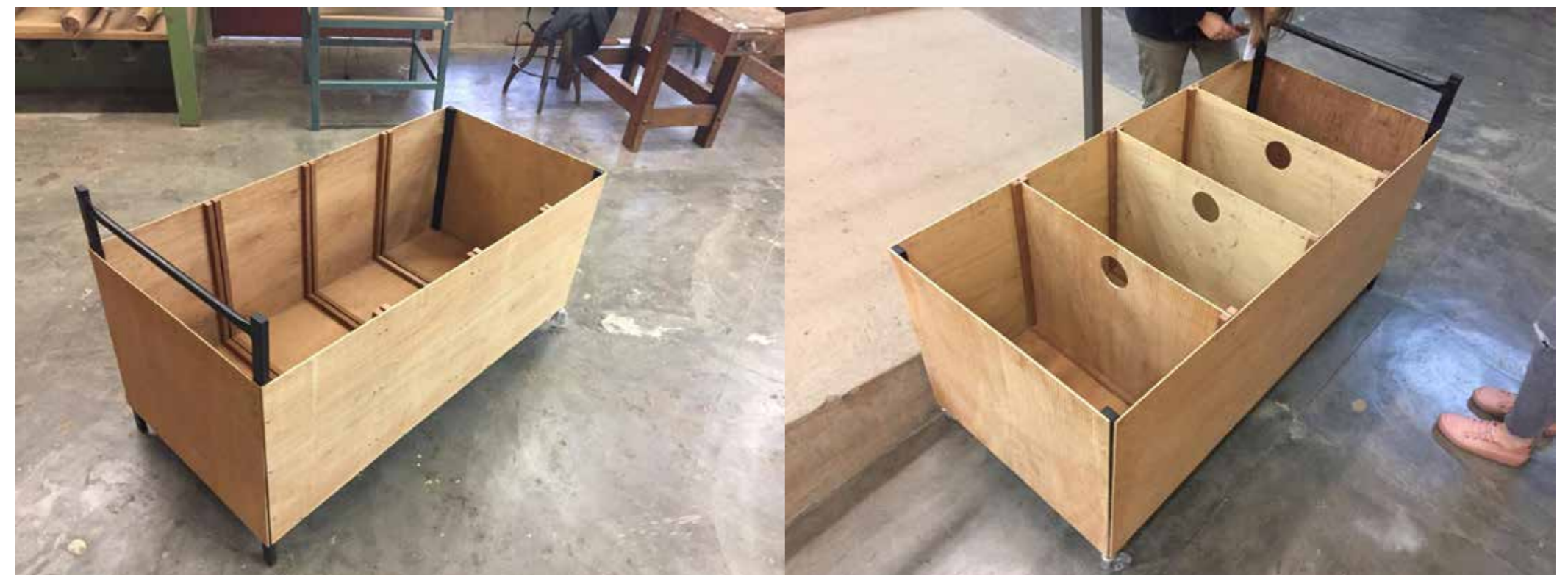
Após a colocação das canaletas, as divisórias foram cortadas, de modo a garantir o manuseio com a perfuração de uma alça em formato circular.
