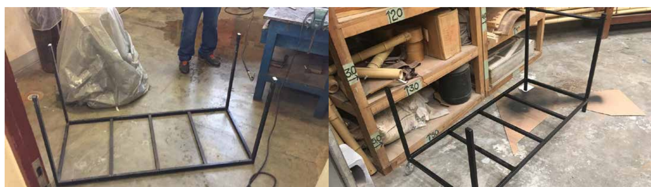
Solda de perfis metálicos com o auxílio do Eduardo, funcionário do LAME, para estruturar a base, com corte na parte superior das pernas, garantindo posteriormente ajuste na altura feito com solda de pés além do acréscimo da barra para auxiliar na mobilidade, assim como as rodas, e para dar acabamento foi realizada a pintura.
