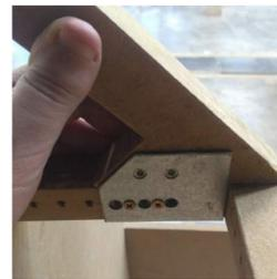
6. Após parafusar as 8 chapas nos quadros que serão a base e o assento/topo, parafuse-as nos quatro apoios. Para isso, utilize parafusos de 20 mm. Complete primeiro os 4 lados de um quadro e parta para o próximo.
