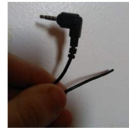
1. Os cabos devem ter comprimento mínimo de 105 cm. Certifique-se que o cabo tenha em uma das pontas um conector com diâmetro maior que o do cabo, e que a outra ponta esteja sem nenhum conector ou acessório.
