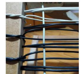
9. Para o segundo par de lados, repita os passos anteriores. Dessa vez, é preciso observar o entrelaçamento dos fios: alterne a passagem deles, sempre um por cima, um por baixo e assim por diante. Após a amarração, a volta do mesmo cabo deve seguir o sentido de entrelaçamento da ida. O próximo cabo deve alternar a passagem em relação ao anterior.
